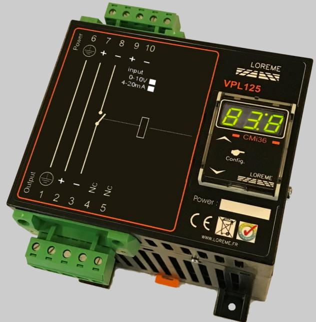
**LE VPL125 est un variateur de puissance pour courant continu en modulation de largeur d'impulsion, destiné aux applications de contrôle de résistances chauffantes.**
